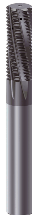
3 Ein Gewindefräser 'GFM Shark D12x32xM1,5', rechtsschneidend und mit Linksspiralnuten und ungleichen Spiralsteigungen, seitlichen Kühlkanalaustritten und AlTiN-Beschichtung
