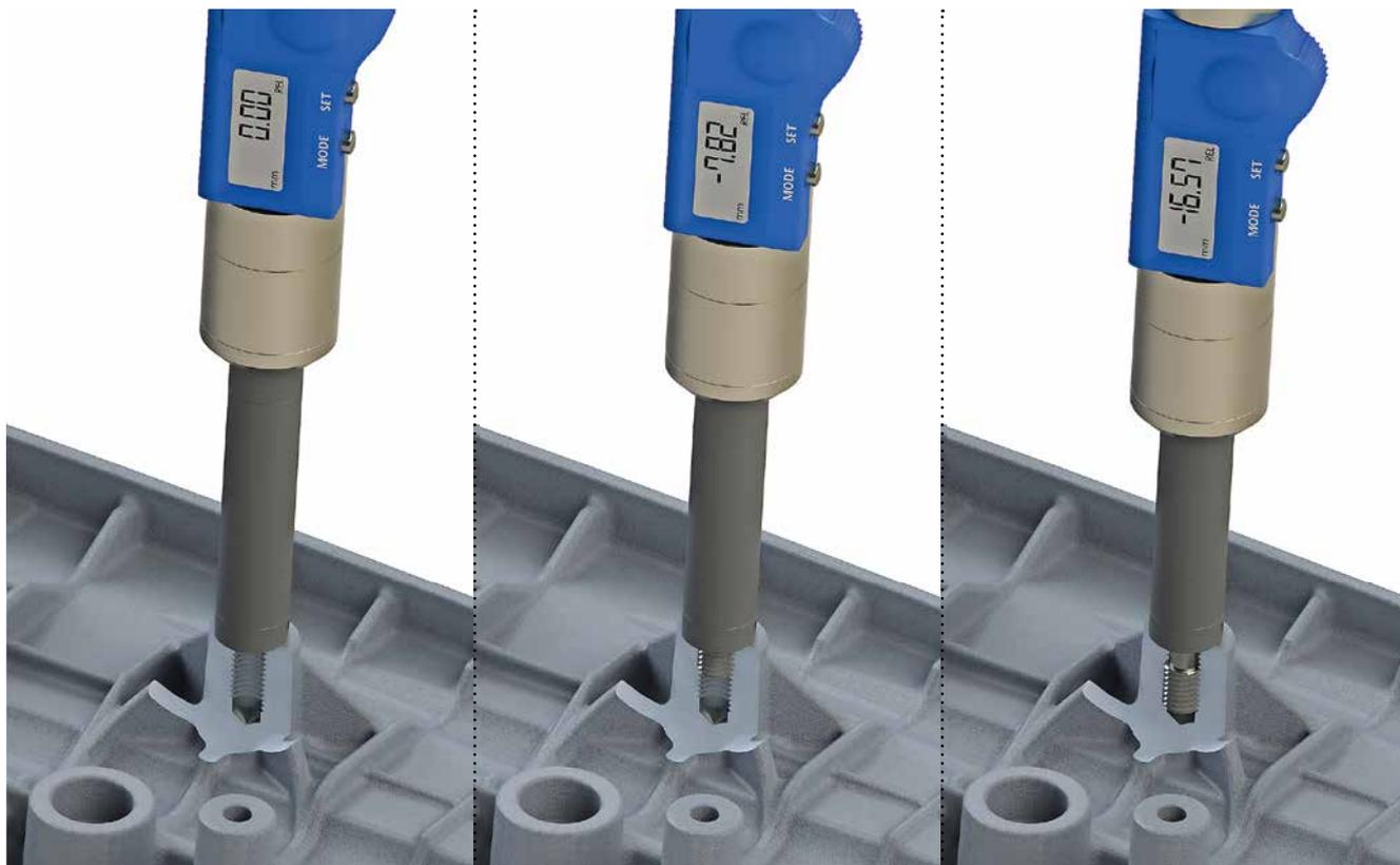
Mit dem MultiCheck-System von JBO lässt sich die Dauer des Gewindeprüfzyklusses um bis zu 50% reduzieren. Die maximale Messtiefe kann bis zu 4xD oder 80 mm betragen.
