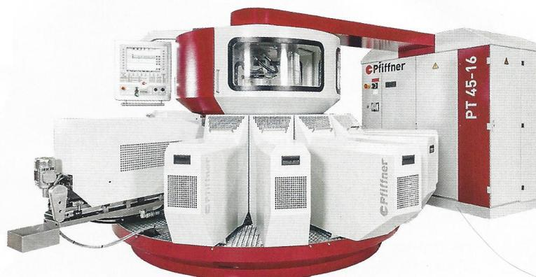
später erneut einen Durchbruch: Die Standzeit lag jetzt bei unglaublichen 200.000 Gewinden pro Schneide, was einer Standzeiterhöhung auf 1.000 % entspricht. Zusätzlich wurde bei der Gewindefräsglocke im Zentrum des Halters ein VHM-Fräser eingebaut. Damit kann Mesa Parts zwei innenliegende Taschen in das Bauteil einarbeiten. Mit dieser Maßnahme wurde am Rundtakter ein Werkzeugplatz frei, der jetzt für andere Bearbeitungen genutzt werden kann. ■
