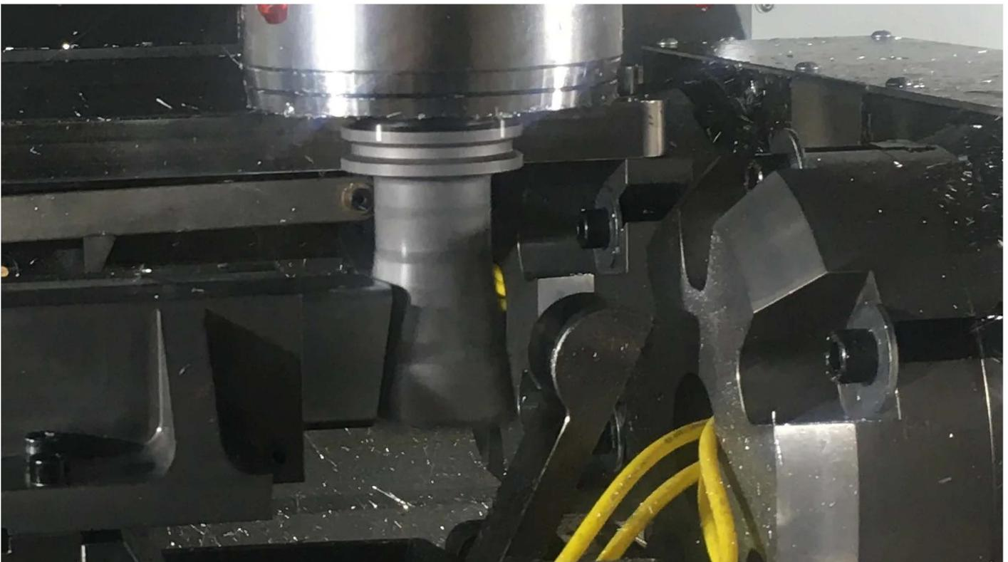
**Taktzeiten minimiert: Nur ein einziger linearer Fräsvorgang reicht in dem Anwendungsfall bei Constellium aus, um die Enden von Profilträgern genau zu bearbeiten, wie es hier zu sehen ist**
