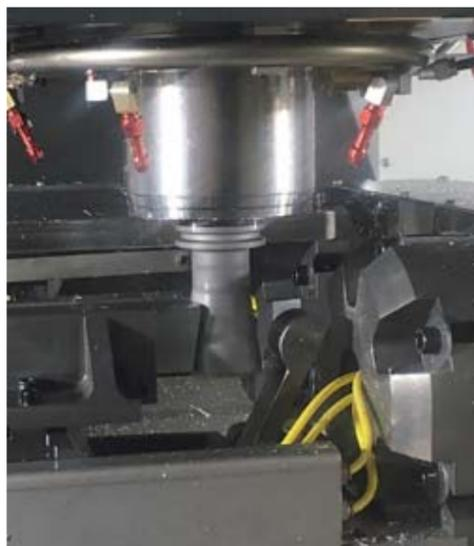
Links: Zu fertigende Geometrie integriert: Sonderwerkzeug mit konisch angeordneten PKD-Schneiden zum Bearbeiten von Enden an Profilträgern aus Aluminium für Fahrzeug-Strukturbauteile. Rechts: Taktzeiten minimiert: Nur ein linearer Fräsvorgang reicht aus, um die Enden genau zu bearbeiten.
