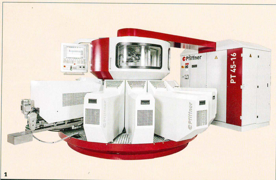
1 Der standfeste Glockengewindefräser von Johs. Boss wird auf einer Pfiffner-Rundtaktmaschine eingesetzt. 2 JBO Glockengewindefräser mit Wechselfräseinsätzen.
