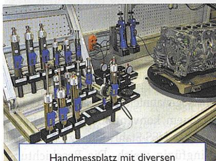
Handmessplatz mit diversen MultiCheck Lehren an einer Fertigungslinie für Zylinderblöcke.
