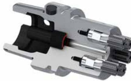
Spezieller Glockengewindefräser für den Einsatz in der Massenfertigung. Aufgrund der ausgeklügelten Konstruktion kann jeder Wechselfräseinsatz bis zu sechs Schneiden zur Verfügung stellen. Dadurch können mit diesem Werkzeug hervorragende Standmengen realisiert werden.
