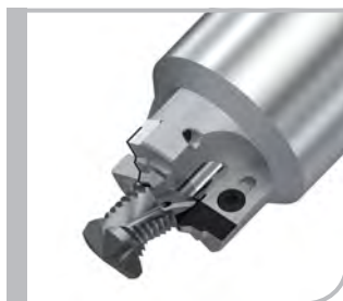
Kombinationswerkzeug mit Bohrgewindefräser M 16 x 1,5 mit IK-Austritt in den Spannuten und drei PKD-bestückten Konturplatten
